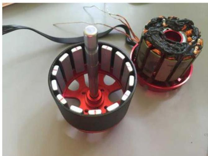
Na obrázku je zobrazena jednoduchá základní konstrukce BLCD motoru. Rotor nasazený na hřídeli je vyložen permanentními magnety, u kterých se střídá polarita (na obrázku magnety s čárkou a bez čárky). Elektronická jednotka napájí cívky statoru tak, že vždy je proti S-pólu permanentního magnetu S-pól elektromagnetu. To samé platí pro J-pól. Tím se magnety od sebe odpuzují a rotor se otáčí.
