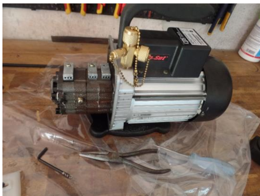
Demontovaný kryt vývěvy
