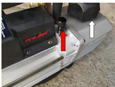
Balastní ventil červená šipka. Plnění oleje a výfuk vývěvy bílá šipka.
