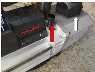
Balastní ventil červená šipka. Plnění oleje a výfuk vývěvy bílá šipka.
